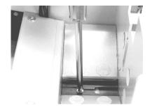
3 ピックアッププレートを上に引張って取り外してください。 (この時、下図のようにM6のボルトを取りつけると楽に取り出せます。)
