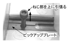
4 サイズに合ったピックアッププレートに交換し、逆の手順で組み立ててください。 ※リベットサイズに合わせて供給高さの調整が必要な場合があります。(P.11参照)
