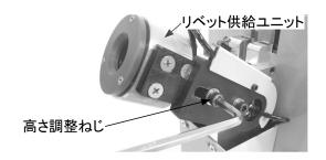
②ご使用されるリベットを吸い込みノズルに差し込んだ状態で、マンドレルの先端から リベット供給ユニット下面までのすき間が1~2mm程度になるように調整を行なってください。
