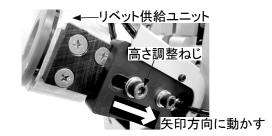
②回転軸を手で矢印方向に回し、止まる位置まで回してください。
