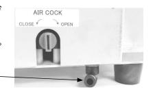
5 コンプレッサーを用意し本機との間に必ず エアーフィルタ・エアーレギュレータ・エアー ルブリケータ(3点セット)を取り付けて
