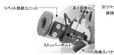
※リベット供給ユニットが脱落しないように 保持した状態で、外してください。
