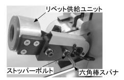
④リベット供給ユニットを芯が合うように動かし、吸い込みノズルと供給ユニットの芯を目視で調整 してください。
