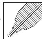
**5** ボディ（フランジ）を装着した状態で、下穴に挿入する。
