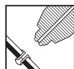
**8** トリガーを放すと、切断されたマンドレルがタンクケースユニットに収納される。
