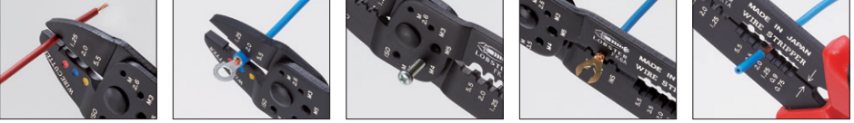
ワイヤーカッター 絶縁端子圧着歯口 (1.25、2、5.5mm) ボルトカッター (適用サイズM2.6～M5) オープンバレル端子圧着 歯口(差込端子1.25、2mm) ワイヤーストリッパー (適用サイズ0.75～5.5mm)
