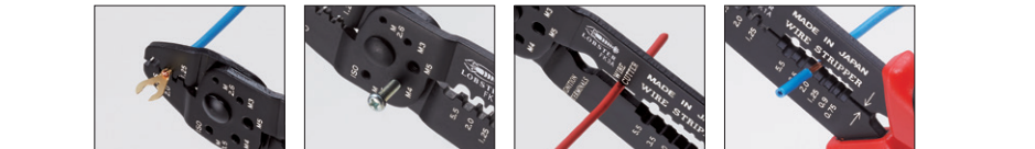
オープンバレル端子圧着 歯口(差込端子1.25、2mm) ボルトカッター (適用サイズM2.6～M5) ワイヤーカッター ワイヤーストリッパー (適用サイズ0.75～5.5mm)
