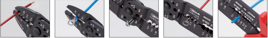
ワイヤーカッター 絶縁端子圧着歯口 (差込端子1.25、2、5.5mm) ボルトカッター (適用サイズM2.6～M5) 裸圧着端子、P.Bスリーブ 用圧着歯口 (1.25、2、5.5mm) ワイヤーストリッパー (適用サイズ0.75～5.5mm)
