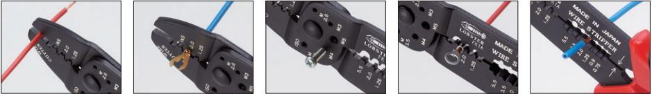
ワイヤーカッター オープンバレル端子圧着 歯口(差込端子1.25、2mm) ボルトカッター (適用サイズM2.6～M5) 裸圧着端子、P.Bスリーブ 用圧着歯口 (1.25、2、5.5mm) ワイヤーストリッパー (適用サイズ0.75～5.5mm)
