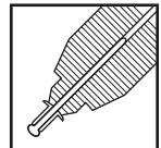
(2) リベッターの先端に、リベットのマンドレル部を挿入する。
