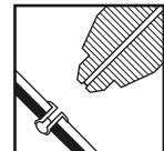
**8** トリガーを放すと、切断されたマンドレルがタンクケースユニットに収納される。
