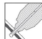
6. リベッターの先端を母材に軽く押しあて、母材等に隙間がないことを確認した後トリガースイッチを引く。
