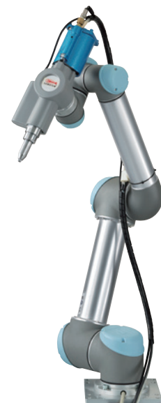
縦型エアリベッター + 協働ロボット
