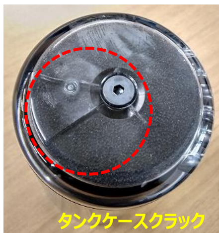
タンクの底部（矢印部）にクラック
